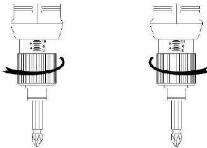
E' possibile bloccare la ghiera tramite un coprifrizione (venduto separatamente). Per posizionarlo correttamente, è necessario togliere l'anello di fermo #2, svitare la ghiera di regolazione #3, svitare e togliere l'anello frontale #1 e sostituirlo con il copri frizione #35 (# 37 nei modelli KBL30).
