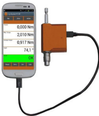
Drehmomentsensor mit Handy verbunden
