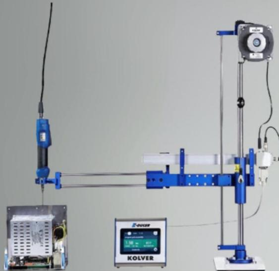
Drehmoment-Reaktionsarme lassen sich mühelos manövrieren und fangen die Drehmomentreaktionen der Schrauber ab, wodurch sie eine ergonomische Unterstützung für den Bediener bieten. Sie reduzieren das Risiko von RSI (Repetitive Strain Injury) und Karpaltunnelsyndrom (KTS) und steigern gleichzeitig die Produktivität.
